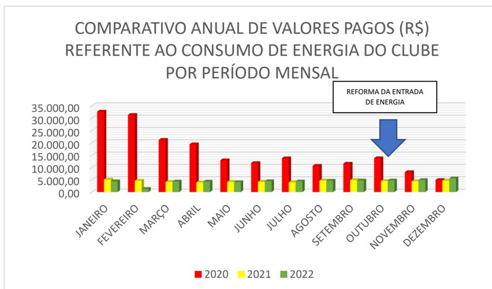
O gráfico mostra que, a partir da reforma no cabeamento de entrada de energia e também da reforma da cozinha na área do economato o consumo diminuiu de maneira significativa. Soma-se a isto a substituição de iluminação para lâmpadas e refletores de LED de menor consumo em diversas áreas do clube. Isto exemplifica como é possível realizar economia sem investimentos de grande monta. O valor dispendido para a substituição do cabeamento alimentador do clube se pagou em 4 meses de
